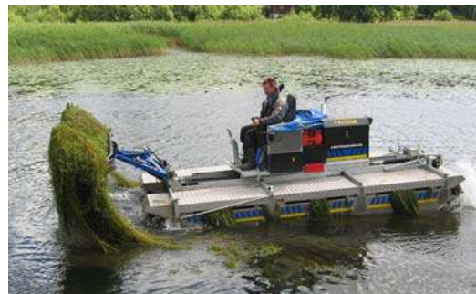
En maskin från Vassmannen AB skördar växter. Framst var det hornsärv och vattenpest som togs upp. Foto: Göran Bardun
